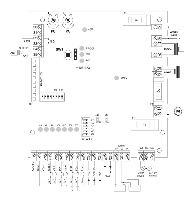
N.B: Non effettuare ponticelli su morsettiera, utilizzare esclusivamente gli appositi Dip-Switch BYPASS
