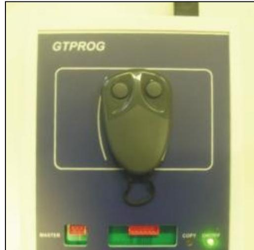
Wenn das verwendete Terminal ein GTSYSTEM ist dann setzen Sie nach Drücken von "OK" den zu programmierenden Sender unter die Programmier-Schnittstelle, drücken Sie den Taster der Schnittstelle und lassen diesen wieder los. Die LED des Senders blinkt, und die LED der Schnittstelle leuchtet fix.
