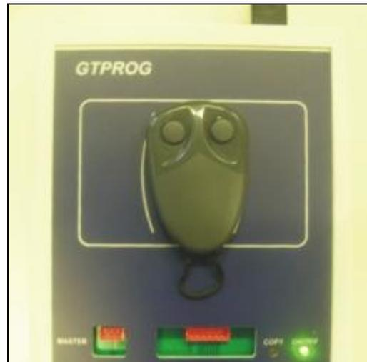
Si le terminal utilisé est un GTSYSTEM, après avoir cliqué sur "OK", mettez l'émetteur à programmer sous l'interface de programmation, pressez puis relâchez le bouton de l'interface. La LED de l'émetteur clignote et la LED de l'interface s'allume en continu.
