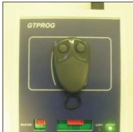
Si el terminal usado es un GTSYSTEM, después de pulsar “OK”, coloque el transmisor que desea programar debajo de la interfaz de programación; pulse y suelte el botón de la interfaz. El led del transmisor parpadea y el led de la interfaz se enciende con luz fija.
