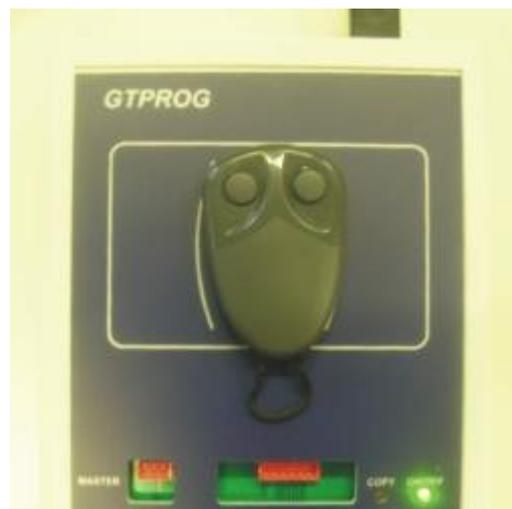
Se il terminale usato è un GTSYSTEM, dopo aver premuto "OK" porre il trasmettitore da programmare sotto l'interfaccia di programmazione, premere e poi rilasciare il pulsante dell'interfaccia. Il LED del trasmettitore lampeggia e il LED dell'interfaccia si accende fisso.
